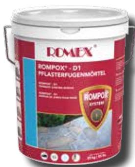
Romex D1 ist ein 2-Komponenten Pflasterfugenmörtel und wird für Einfahrten und Zufahrten bis 7,5 Tonnen verwendet. Empfohlene Fugenbreiten ab 3 mm. Für Fugentiefen ab 30 mm. Vakuumverpackt. Für beschichtete und empfindliche Gesteinsarten geeignet.
