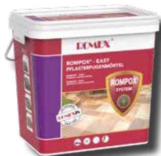
Romex Easy ist ein fix und fertig gemischter 1-Komponenten Pflasterfugenmörtel und wird für Terrassen und Gehwege sowie durch leichte, gelegentliche Pkw-Belastung belasteten Flächen rund ums Haus eingesetzt. Empfohlene Fugenbreiten ab 5 mm. Für Fugentiefen ab 30 mm. Vakuumverpackt. Für beschichtete und empfindliche Gesteinsarten geeignet.
