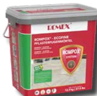
Romex ecofine ist ein fix und fertig gemischter, schlämmfähiger 1-Komponenten Pflasterfugenmörtel. Für 2 cm starke keramische Platten bei gebundener wasserdurchlässiger Verlegung. Für eng verlegte Pflaster und Plattenbeläge. Frost-, chlorresistent und tausalzbeständig. Schlämmbar ohne Qualitätsverlust. Keine Versiegelung der Fuge.
