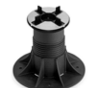
Stelzlager mit selbstnivellierendem Kopf Höhe: 120 - 170 mm, Ø 205 mm (SE4)
